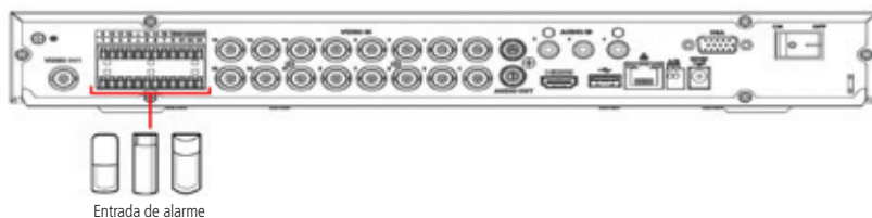
Entrada de alarme
