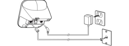
Conexão da linha telefônica e do adaptador de tensão
