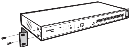
Instalação dos suportes na central
