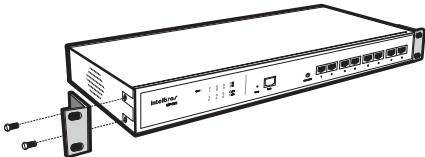
Instalación de los soportes en la central
